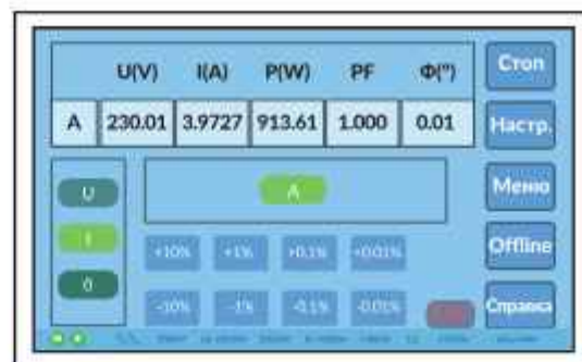
Рисунок 4.2.3.1.2. Окно режима подстройки (I) блока управления HS-6611
