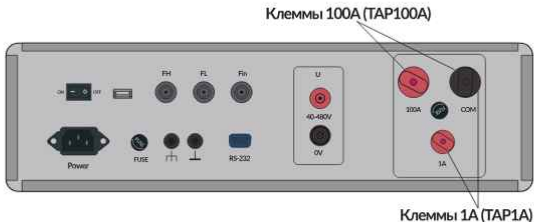
Рисунок 4.3.6.7. Токвые клеммы диапазонов 100 А и 1 А
