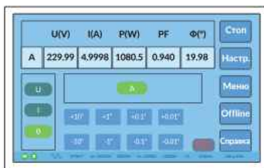
Рисунок 4.2.3.1.3. Окно режима подстройки (углы) блока управления HS-6611
