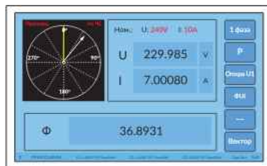
Рисунок 4.3.3.2. Экран векторной диаграммы с векторами фиксированной длины
