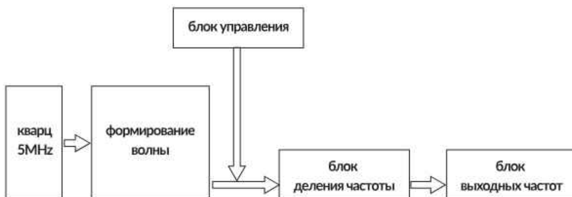
Рисунок 4.4.3. Схема блока проверки точности хода часов HS-1012C
