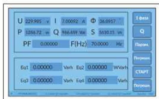
Рисунок 4.3.4.4. Экран расчёта энергии по реактивной Q мощности
