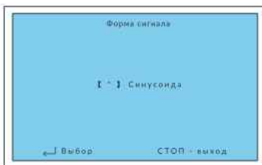
Рисунок 4.2.2.5. Меню выбора формы тестового сигнала (синусоида)
