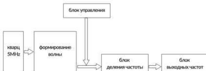
Рисунок 4.4.3. Схема блока проверки точности хода часов HS-1012C
