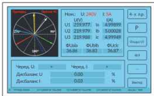
Рисунок 4.3.3.1. Экран векторной диаграммы в режиме фU
