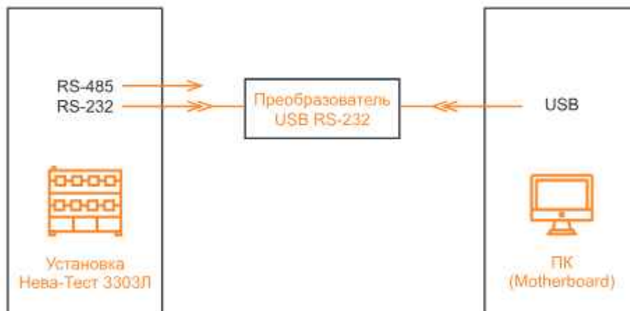
Рисунок А.2. Схема подключения Установки к ПК через преобразователь интерфейсов USB-RS232
