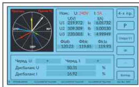
Рисунок 4.3.3.3. Экран векторной диаграммы в режиме фI
