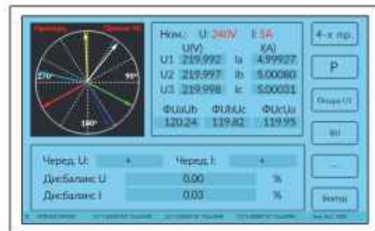
Рисунок 4.3.3.2. Экран векторной диаграммы в режиме фI
