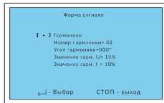
Рисунок 4.2.2.8. Меню выбора формы тестового сигнала (гармоники)
